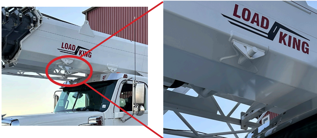
Shift Pins on Boom
